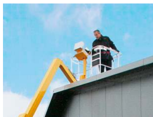
Úhlový výložník umožňující přemostění
